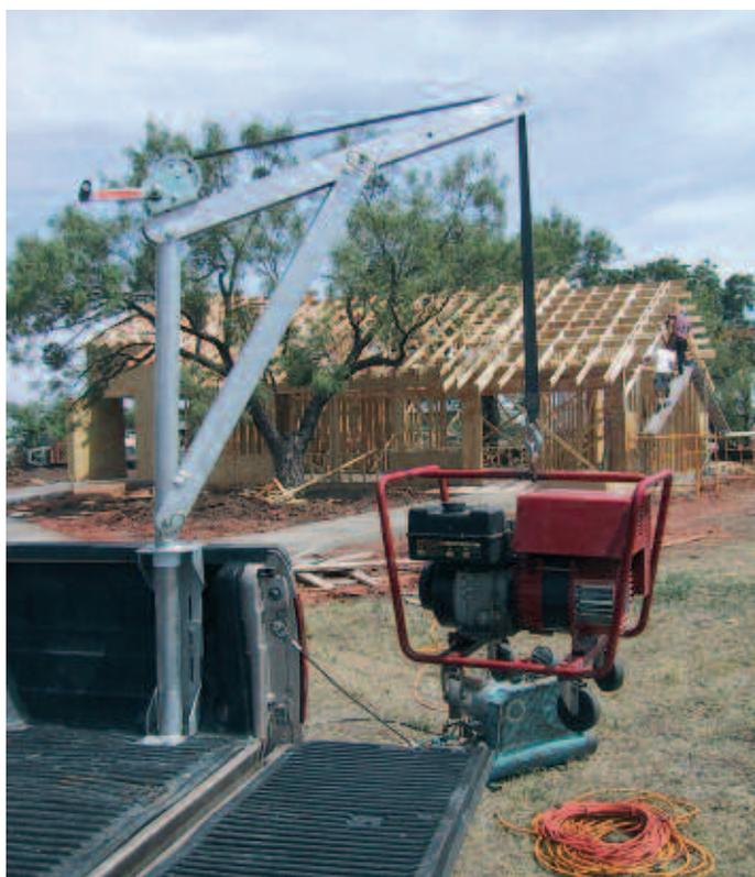
lo secondo le necessità. Esistono vari tipi di basi di fissaggio per la Spitzlift che possono fissarsi in diversi punti dei veicoli; alcuni utilizzatori la montano anche su imbarcazioni, o la fissano al suolo o su un terrazzo.
