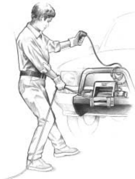
Fase 19: RIAVOLGERE LA FUNE METALLICA. La persona che maneggia la fune metallica durante il riavvolgimento non deve lasciare scorrere la fune tra le mani, ma deve accompagnarla e controllare costantemente il verricello.
