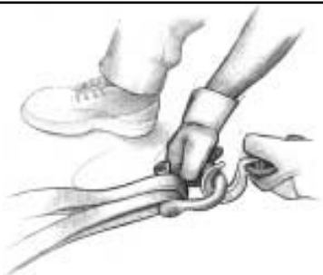
Fase 18: STACCARE LA FUNE METALLICA. Staccare dall'ancoraggio.
