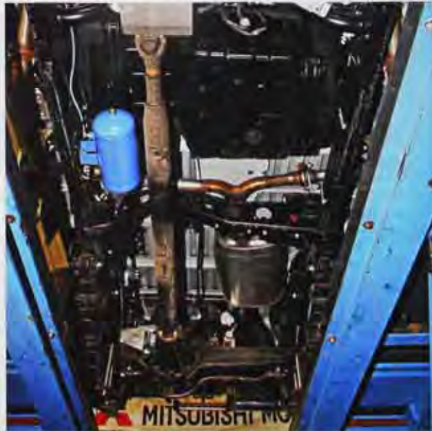
Una soluzione tipica per installare un serbatoio di aria compressa al di sotto di un 4x4. Su questo Toyota, ad esempio, è stata montata una bombola da 7,5 litri e 11 bar di pressione massima. Molti ricorrono ad altri esemplari per accumulare aria, come fucine e dotate di attacco sigillato alla le protezioni laterali sia i paraurti opportunamente realizzati. L'obiettivo in ogni caso è sempre quello di avere una maggiore riserva d'aria possibile.
