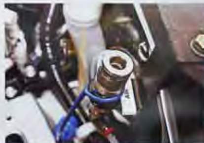
Quando si monta un compressore a bordo generalmente si realizza anche un impianto di distribuzione dell'aria compressa, in modo da avere degli attacchi all'interno del cofano, nell'abitacolo e nel bagagliaio.
