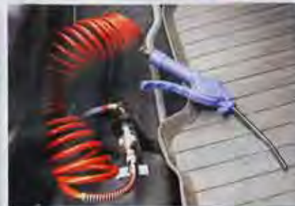
Tramite gli attacchi a scatto è possibile collegare le pistole gonfiagomma, ma anche quelle per soffiare via la polvere... molto utili ad esempio nel deserto. Le pistole per svitare dadi e bulloni andrebbero collegate solo su impianti con serbatoio capiente e supportati da un compressore con una grande portata.
